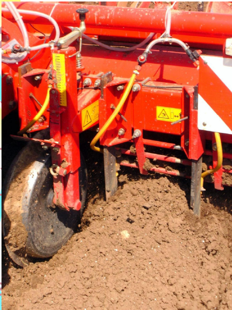
Düngerapplikation beim Dammerfräsen durch Applikationsschare
