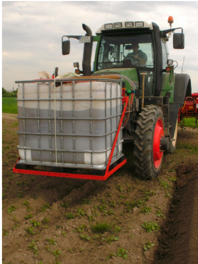
Düngertank im Frontanbau, Pumpe hydraulisch betrieben
