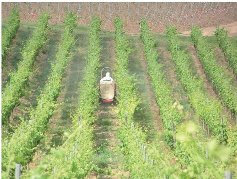
*Abb. 4 | Vermeidung abdriftgefährdeter Feintropfen durch Verwendung von verlustmindernden Düsen, hier AVI 80 015. Sprühwolken sind nicht mehr erkennbar.*
