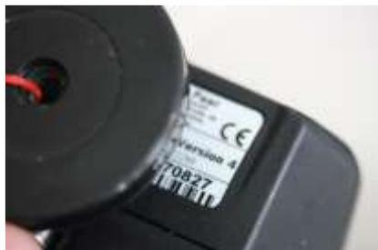
Abbildung: Die RFID Schnittstelle ist beim Typenschild auf der Rückseite des Gerätes positioniert
